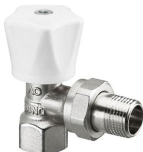
Poignée manuelle blanche. Kvs : 1.45. Pression différentielle max. : 1 bar. Pression de service max. : 10 bar. Température de service max. : 120 °C.
