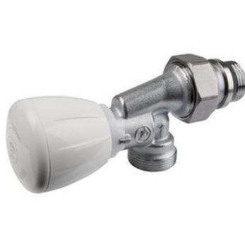
Robinet thermostatisable. Douille auto-étanche. Modèle équerre inversé. Préréglage par volant manuel. Fabriqué en laiton chromé. Livré sans adaptateur.
