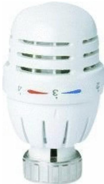
Tête thermostatique avec capteur en cire et dispositif de blocage de la température. Pour toutes les vannes thermostatiques Pettinaroli (M28 x 1,5). Conforme à la norme EN 215.
