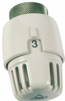
Tête thermostatique TL 10 à dilatation de liquide destinée à être posée en position horizontale. Sonde intégrée. Corps en polycarbonate. Possibilité de bloquer la molette sur une position correspondant à la température souhaitée. Réglage de la Température de 1 à 5. Valeur de réglage 7...30°C. Pression maxi 10b. Variation temporelle 0.38K.
