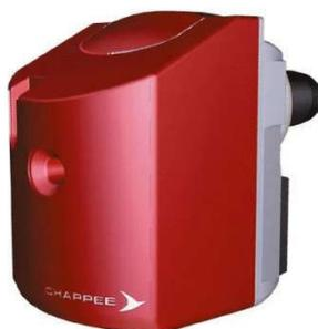
Compatible avec toutes chaudières canon en 80 et 90 mm. Brûleur de dernière génération économique et silencieux. Fonctionnement sûr et performant. Carter en aluminium injecté. Tuyère de combustion en acier inoxydable. 2 flexibles Long 1m avec raccords tournants 3/8" femelle. Bride de fixation universelle fournie (coulissante). Joint d'étanchéité. Gicleur 0,55g 45° fourni, monté. Connecteur mâle 7 broches de raccordement chaudière. Clé de réglage 6 pans fournie. Vis de fixation M8.
