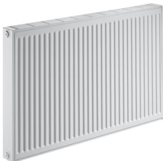
Radiateurs horizontaux en tôle d'acier de haute qualité traitée anti-corrosion, laqués d'une peinture époxy polyester de couleur RAL 9016 cuite au four. S'adaptent à tout type d'installation monotube, bitube, hydrocâblée. Raccordement latéral ou en diagonale. Livrés d'origine avec 1 bouchon plein + 1 bouchon purgeur ainsi qu'avec le système de fixation au mur.
