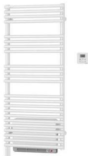
Radiateur sèche-serviettes en acier. Tubes émetteurs ronds horizontaux Ø 25 mm. Collecteurs ronds Ø 38 mm verticaux, épaisseur 1.5 mm. Traitement de surface par bains de cataphorèse et finition par revêtement en poudre époxy/polyester. Teinte de base blanc 603 (RAL 9016). Fluide : huile minérale inaltérable, haute performance et biodégradable. Résistance électrique thermoplongeante à coupe-circuit automatique. Soufflant 1000W dans la teinte du radiateur. Nouvelle régulation infrarouge IRS.
