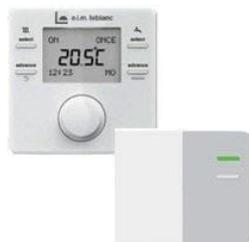
Régulation d'ambiance : Possibilité de prendre en compte la température extérieure. Programmation hebdomadaire chauffage et ECS. Affichage des consommations gaz et électriques de la chaudière pour les postes chauffage et eau chaude sanitaire.
