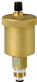
Purgeur d'air automatique en laiton équipé d'un véritable mécanisme à pointeau avec ressort de rappel et joint torique détaché. Avec clapet automatique. Température maxi 110°C. Pression maxi 10 bar.
