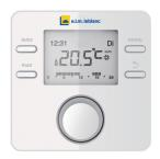
Régulation d'ambiance sans sonde extérieure. Programmation Hebdomadaire. Régulation d'ambiance sans prise en compte de la température extérieure. Permet de gérer 1 circuit chauffage, 1 circuits ECS, 1 circuit solaire. Programmation hebdomadaire chauffage et ECS.
