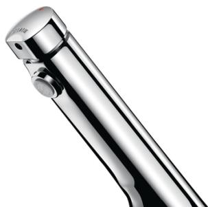
Déclenchement souple. Temporisation ~7 secondes. Débit préréglé à 3 l/min à 3 bar, ajustable de 1,5 à 6 l/min. Brise-jet antitartre inviolable. Corps en laiton massif chromé M1/2". Livré avec un repère bleu et un repère rouge. Adapté aux PMR. Existe avec Fixation renforcée par contre-écrou à 3 vis Inox.
