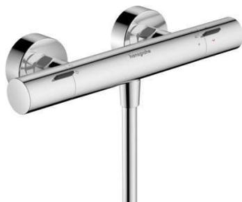
1 fonction. Contrôle de la température et du débit. Le bouton Ecostop+ limite la consommation d'eau à 6 l/min. Cartouche thermostatique. Débit maximal à 3 bars : 17 l/min. Fonction safety stop à 40 °C. Limiteur de température réglable. clapet anti-retour. Avec silencieux. Matériau des poignées : métallique. Distance du centre: 150 mm ± 12 mm. Type de raccordement: raccords S, G 1/2. Filtre à poussière inclus.
