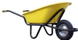
La brouette OLYMPIC RÉNO est une brouette à destination des extra-pro, qui recherchent la qualité. Grâce à une épaisseur de caisse importante de 1,2 mm, un double châssis à pieds tubulaires incorporés et un arceau de sécurité Ø 32mm, cette brouette est hyper robuste et s'adressera en 1er lieu aux experts du bâtiment ! Sa caisse étroite de 110L permet de passer facilement les portes enintérieur. Diamètre de roue : 38 cm.
