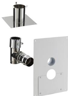
Permet la rénovation et l'adaptation d'un conduit traditionnel carré départ plafond au système PGI. Les fumées sont évacuées dans un tubage flexible, l'air comburant est acheminé par la lame d'air située entre le tubage et le boisseau.
