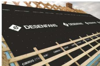
Écran de sous-toiture permettant de protéger la toiture de l'eau et de l'air, tout en laissant la vapeur d'eau s'échapper tel un « manteau respirant ». Masse surfacique : 160 g/m<sup>2</sup>. Épaisseur : 0,7 mm. Réaction au feu : Classe E. Absorption d'eau : Classe W1. Perméabilité à la vapeur d'eau : Sd = 0,02 m.
