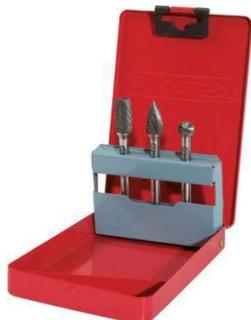
Surface polie. Fraisage optimal grâce la denture croisée. Diamètre de tige 6 mm. Acier haute performance. Utilisation : métaux durs, inoxydables, résistants aux acides et aux hydrocarbures, fontes...
