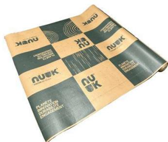
Pare-vapeur plus écoresponsable, pour combles aménagés, combles perdus et murs ossature bois avec revêtement extérieur ventilé. Étanche à l'air, étanche à la vapeur d'eau, 170 g/m<sup>2</sup>, haute résistance mécanique, valeur Sd 20 m.
