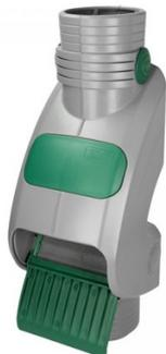
Collecteur et filtre universel s'installant facilement sur le bas des descentes de gouttière. Rejette les impuretés (feuilles, mousses?) par l'avant et alimente en eau de pluie la cuve GLOBUS. Maille : 1 mm. Ø entrée 80/100 mm - Ø sortie 80/100/110 mm. Hauteur : 505 mm. Profondeur : 216,5 mm.
