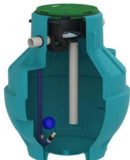
Cuve en polyéthylène 100 % recyclable. Pose enterrée. Equipée d'un Filtre, d'un trop-plein anti-rongeurs et d'un Kit d'aspiration cette Cuve est utilisée pour la récupération et l'utilisation avec une pompe des eaux de pluie.
