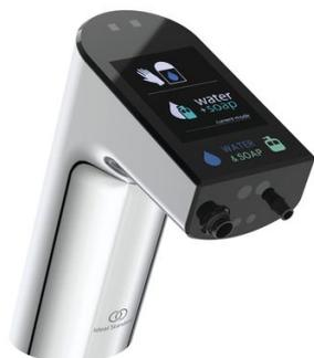
Robinet de lavabo sans contact avec distributeur de savon liquide intégré - temps de lavage et frais d'exploitation réduit. Montage monotrou. Conception : chromé. Sans mitigeur d'eau chaude et d'eau froide. Avec source d'alimentation 100-230 V AC, 50-60 Hz, 6 V DC. Distributeur de savon intégré pour savon mousse. Rinçage automatique de l'eau et du savon, désinfection thermique, mode de nettoyage.
