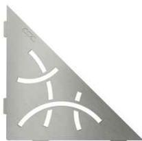
La tablette d'angle triangulaire Schlüter-SHELF-E-S1 pour montage en angle de mur garantit une grande flexibilité. Elle peut être mise en ?uvre lors de la pose des carreaux ou insérée ultérieurement dans les joints de murs déjà carrelés, grâce aux languettes de fixation de seulement 2 mm d'épaisseur. Il n'est donc pas nécessaire de percer et votre carrelage reste définitivement intact.
