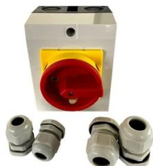
Modèle compatible avec 90% des applications 32/25/20/16 A et 2/3/4 P. Livré avec 2 jeux de presse-étoupes M20 et M25. Protection boîtier IP65 Boîtier polycarbonate robuste pour conditions extrêmes. Facilité d'installation. Protection des installations. Cadenassable en position OFF. Norme EN 60947-3.
