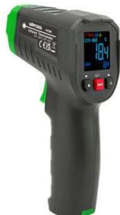
Plage de mesure : 50 - 500°C. Précision +/- 0,2%. Temps de réponse ?250 ms (95 % de la lecture). Température de fonctionnement 0 - 50°C.
