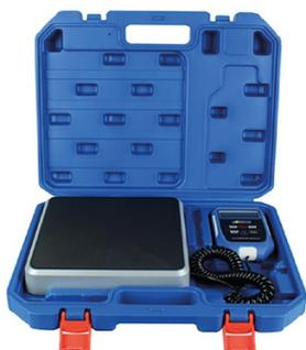
Balance électronique - 0 à 100 kg - précision +/- 0,5%. Température d'utilisation -10°C à +50°C. Plateau 230x230 mm. Ecran 67x25 mm. Alimentation batterie 9V fournie.
