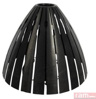
Ramspot LS est un accessoire permettant la pose de spot encastrable sur plaque de plâtre dans un plafond isolé par de l'isolant soufflé ou projeté. Il crée un volume d'air suffisant et nécessaire à la dissipation de chaleur. La pose du RAMSPOT LS se fait par en dessous, sans accès aux combles.
