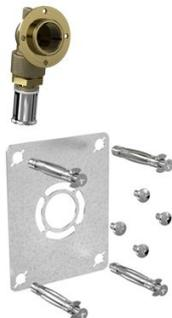
La platine peut se fixer sur une plaque de plâtre type BA13 grâce aux chevilles à expansion fournies. Les chevilles devront être modifiées en cas d'installation prévue en extérieur (robinet de jardin). La platine peut soit être recouverte de carrelage soit équipée d'un cache de finition esthétique vendu séparément.
