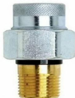
Le raccord diélectrique bimétallique non tournant permet de raccorder tout type de chauffe-eau, en effet il s'installe directement entre la tubulure eau froide du ballon et le groupe de sécurité en laiton, l'avantage est qu'il va limiter les risques de corrosion et la circulation de courants vagabonds.
