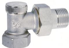
Coude de réglage gamme "A" 1/2" Nickel sans joint sur la douille. Isolement du radiateur. Réglage du débit de retour, équilibrage des circuits. Corps laiton matricé, CW617N nickelé ou chromé (CH). Joint d'étanchéité entre corps et douille Avec joint sur la douille de montage (gamme N et CH). Pression maxi.
