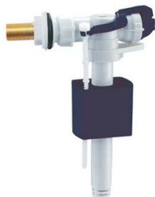
Alimentation latérale. Raccordement 3/8 laiton. Fermeture hydraulique. Design compact : approprié à tout type de réservoir. Vis de réglage du niveau d'eau. Membrane en silicone. Accès à la membrane sans démontage du robinet. Résiste à la corrosion. Fermeture stable à différentes pressions. Fonctionne à basse pression. Peu sensible aux impuretés. Fermeture instantanée. Filtre sur arrivée d'eau.
