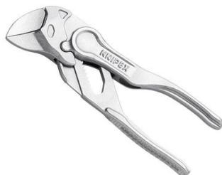
Accessibilité optimale, design particulièrement compact, tête très fine. Réglage précis à une seule main. Immense capacité de préhension. L'action de la mâchoire parallèle saisit en continu avec une ouverture pouvant atteindre 21 mm. L'articulation coulissante robuste procure stabilité et durabilité. Mâchoire polie. Ergot de protection évitant les pincements. Réglage fin avec 10 positions de réglage.
