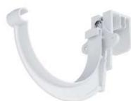
Simplifiez l'installation de votre gouttière demi-ronde GD25 en utilisant ce crochet avec sa patte support, elle se fixe sans difficulté sur une planche de rive. Vous pouvez ensuite clipser la gouttière en quelques secondes et obtenir une fixation discrète et propre pour votre système d'évacuation des eaux pluviales. Ils sont à positionner sur toute la longueur de la gouttière (intervalle de 60 cm maximum) et à chaque extrémité.
