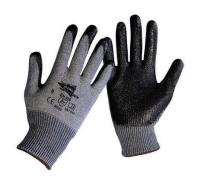
Souplesse, confort et précision. Résistance maximale à l?abrasion. Résistance maximale à la coupure. Idéal pour la manutention moyenne. Adapté pour une utilisation en milieu sec, aqueux ou huileux. Type de montage : tricot. Support : TAEKI5 composite. Enduction : nitrile imperméable - paume. Jauge : 13. Poignet élastique.
