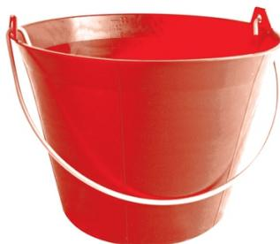
Seau plastique 11 litres. Polyéthylène recyclé, injecté garantissant une résistance à 60 kg. Graduation moulée dans la masse. Fond nervuré pour faciliter la prise. Assemblage de l'anse par bouterollage.
