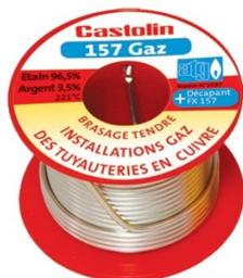
Destiné à l'assemblage de tuyauteries en cuivre pour le gaz : Alliage eutectique de brasage capillaire tendre exempt de plomb, ayant d'excellentes caractéristiques mécaniques, de liaison et une capillarité exceptionnelle même sur acier inoxydable. Apport de chaleur très faible évitant la déformation des pièces.
