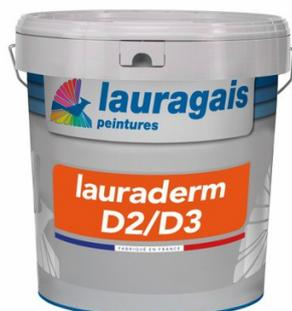
Revêtement semi-épais pour la décoration des façades, formulé à base de résine acrylique en phase aqueuse et de résine polysiloxane. Surfaces murales verticales. Anciennes ITE (Isolation thermique par l'extérieur) : solution K1 ou K2. Bonne résistance aux intempéries. Masque efficacement le faïençage. Très bonne perméabilité à la vapeur d'eau. Pas d'encrassement du film de peinture. Rendement :  $\pm 250 \text{ gr/m}^2$  (classe D2) par couche.  $\pm 350 \text{ gr/m}^2$  (classe D3) par couche.
