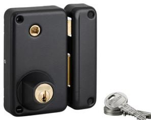
Coffre et gâche acier embouti. Pêne et demi-tour acier zingué. Mécanisme à 2 tours. Rappel du demi-tour par la clé. Carré 7mm. Entrée de cylindre laiton. Double cylindre laiton à 5 goupilles. Ø 23 mm long. 45 mm. 3 clés nickelées.
