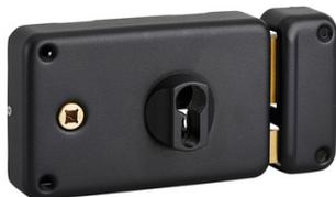
Coffre et gâche acier embouti. Pêne dormant et pêne 1/2 tour acier zingué. Mécanismes 2 tours. Rappel 1/2 tour à l'équerre. Entrée de cylindre et de fouillot en laiton. (Sens poussant sur demande). Carré 6 mm. Dimensions : 140 x 88 mm Finition : époxy noir granité. Livré sans cylindre.
