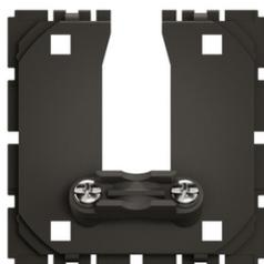
Sortie de câble Céliane à compléter d'un support universel Batibox et à combiner avec un enjoliveur et une plaque de finition. Connexion par câble rigide 2.5mm<sup>2</sup>. Pour câbles Ø5mm à Ø13mm. Peut être installée en encastré (dans boîte d'encastrement) ou en saillie (sur cadre saillie).
