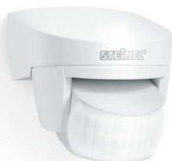
Le grand classique avec encore plus d'avantages. Détecteur de mouvement infrarouge IS 2140 ECO pour l'intérieur et l'extérieur, idéal pour la détection ciblée dans et autour de la maison, angle de détection de 140°, portée jusqu'à 14 m, temporisation et seuil de déclenchement réglables, détecteur orientable de 180° à l'horizontale et de 90° à la verticale permettant une adaptation exacte à la zone de détection.
