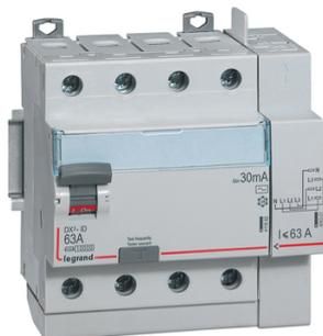
DX<sup>3</sup>-ID interrupteur différentiel modulaire tétrapolaire, détecte les fuites de courant dues à des défauts d'isolement coupe immédiatement l'alimentation du circuit concerné lors d'un contact accidentel avec le courant
