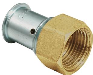
Fabriqué en laiton, ses douilles de sertissage possèdent une lumière d'inspection pour contrôler la profondeur d'enfoncement du tube, taraudage selon DIN EN 10226-1.
