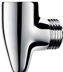
Raccord antistagnation en laiton massif chromé pour vidange automatique du flexible de douche et de la douchette. Empêche toute stagnation d'eau et limite la prolifération des bactéries. Arrivée F1/2" avec joint filtre à raccorder sur la sortie basse de la robinetterie. Sortie M1/2" à raccorder au flexible.
