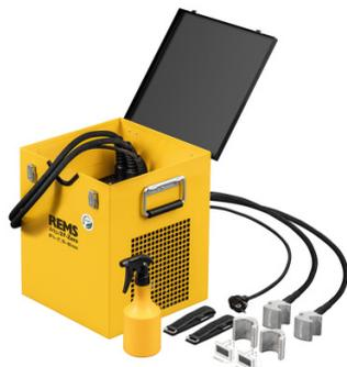
Appareil électrique à congeler les tubes avec circuit frigorifique fermé. Pour tubes en acier, cuivre, plastique et multicouche Ø 1/8 - 2", Ø 10-60 mm. Unité de congélation 230 V, 50 Hz, 430 W, 2 tuyaux pour frigorigène, longueur 2,5 m. 2 têtes de congélation Ø 1/4-11/4", 15-42 mm. 2 colliers de serrage, 2 thermomètres numériques LCD, vaporisateur. Dans caisse métallique solide. Dans boîte carton.
