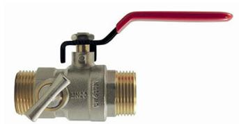
Vanne en laiton matricé, nickelé sur les surfaces extérieures. Conçue, fabriquée et contrôlée selon la norme européenne EN 13828. Passage standard. Etanchéité par double joint torique EPDM. Axe inéjectable. Embouts taraudés BSPP (gaz) selon norme ISO 228-1. Portées planes pour réaliser une étanchéité par joint plat. Poignée réversible avec indication du sens de manoeuvre ON/OFF. Etanchéité testée à 100% en usine. Avec Purge
