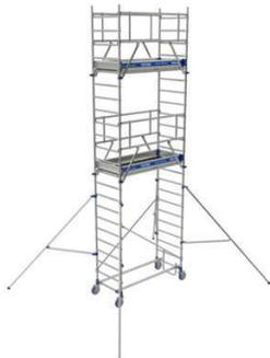
Le Totem 2 Line 180 est un échafaudage roulant en aluminium certifié NF. Son système de liaison breveté Ergoblock, permet un blocage fiable en un seul geste. Ses plinthes de 150 mm en aluminium amovibles sont rapides à mettre en place, sans vis ni outils. Ses roues de 200 mm de diamètre sont réglables sur 175 mm et tous les 12,5 mm. Il répond à la norme EN 1004-1 et au décret 2004-924.
