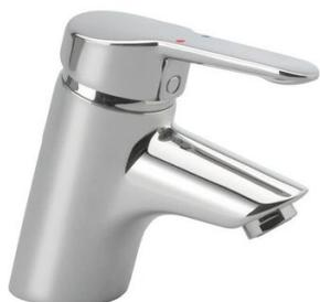
Chromé. Bec fondu fixe avec jet incliné. Brise jet fourni. Corps monobloc en laiton chromé. Cartouche 47 mm à 2 disques céramique Click Technology équipée d'un limiteur de température réglable et d'un limiteur de débit déverrouillable. Axe de commande de la cartouche en métal. Manette métal pleine fixée par vis pointeau antidesserrage et isolateur thermique. Capot de protection de cartouche. Résiste aux chocs thermiques jusqu'à 80° C pendant 60 mn. Flexibles SPX longueur 350 mm.
