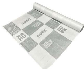
Un écran pare-pluie permet d'éviter que l'eau et l'air ne s'engouffrent dans les parois, tout en laissant la vapeur d'eau potentiellement présente dans la paroi s'échapper. Diffuse la vapeur, résistant à la pénétration de l'eau (Classe W1), perméable à la vapeur d'eau ( $S_d : 0,02$  m), résistant à la traction (MD : 250 N/50 mm - CD : 160 N/50 mm). Haute résistance mécanique, résistance 3 mois en phase chantier. Certifié QB38 par le CSTB. Fabriqué en Europe.
