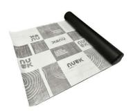
Écran de sous-toiture pour entraxe de 90 cm entre chevrons. Haute résistance mécanique, jusqu'à 3 mois d'exposition en phase chantier pour une utilisation en façade, perméable à la vapeur (Sd: 0,02 m), étanche à l'eau (W1), résistant à la traction (MD: 400 N/50 mm - CD: 330 N/50 mm) et recyclable. Certifié QB par le CSTB. Idéal pour les toits en pentes ventilés.
