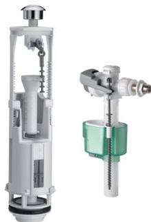
Ensemble mécanisme de chasse + Robinet flotteur. Modèle double touche avec trop-plein télescopique ajustable manuellement. Fermeture hydraulique. Silencieux. Economie d'eau. Peut être adapté avec les trous de couvercle Ø de 16 à 50 mm et les trous d'évacuation Ø de 58 à 72 mm. Ne pas exercer un serrage excessif au risque de détériorer le robinet. Il est nécessaire d'étancher le raccordement au réservoir avec le joint fibre ou filtre.
