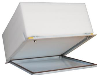
R = 8,24. U = 0,123. Etanchéité à l'air > 100 Pa. Isolant : Ouate de polyester 280 mm, densité 23,5 kg/m<sup>3</sup>. Amélioration acoustique 54 dB. Tôle d'acier DX51D, zinguée Z275 MA, finition blanc mat. Système d'ouverture : poussez/lâchez. Montage rapide et simple, fixation par pattes métalliques.
